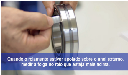
Neste exemplo iniciamos a medição com uma lâmina de 0.08 mm.
