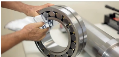
Atenção: Rolamentos novos devem ser retirados de sua embalagem somente no momento da montagem
